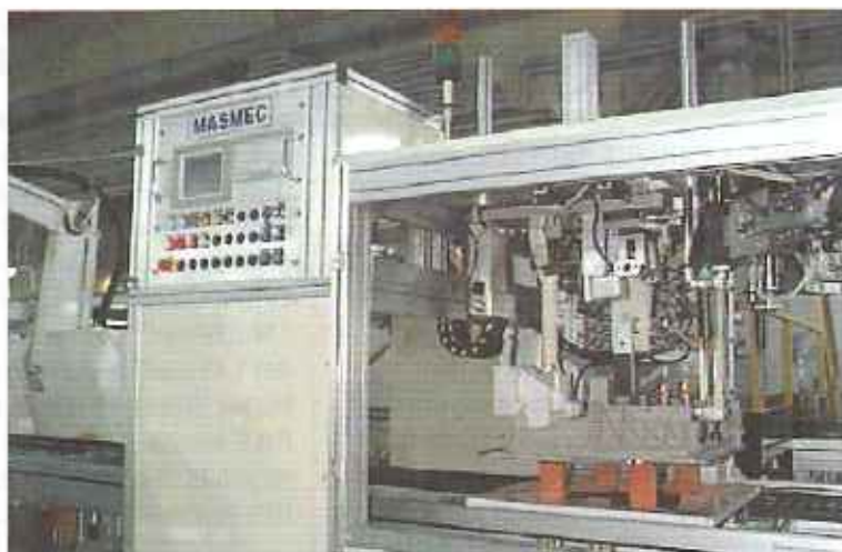
Applicazione di Modulo Prova Tenuta MPT2K presso la stazione collaudo basamento di lavatrici.
