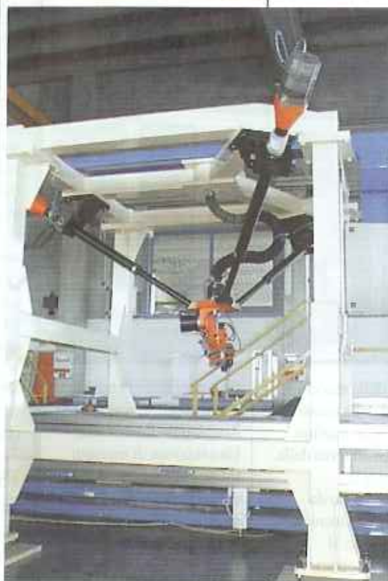
Applicazione industriale di macchina a cinematica parallela PKM per il montaggio del tubo di scarico sul basamento della lavatrice.
