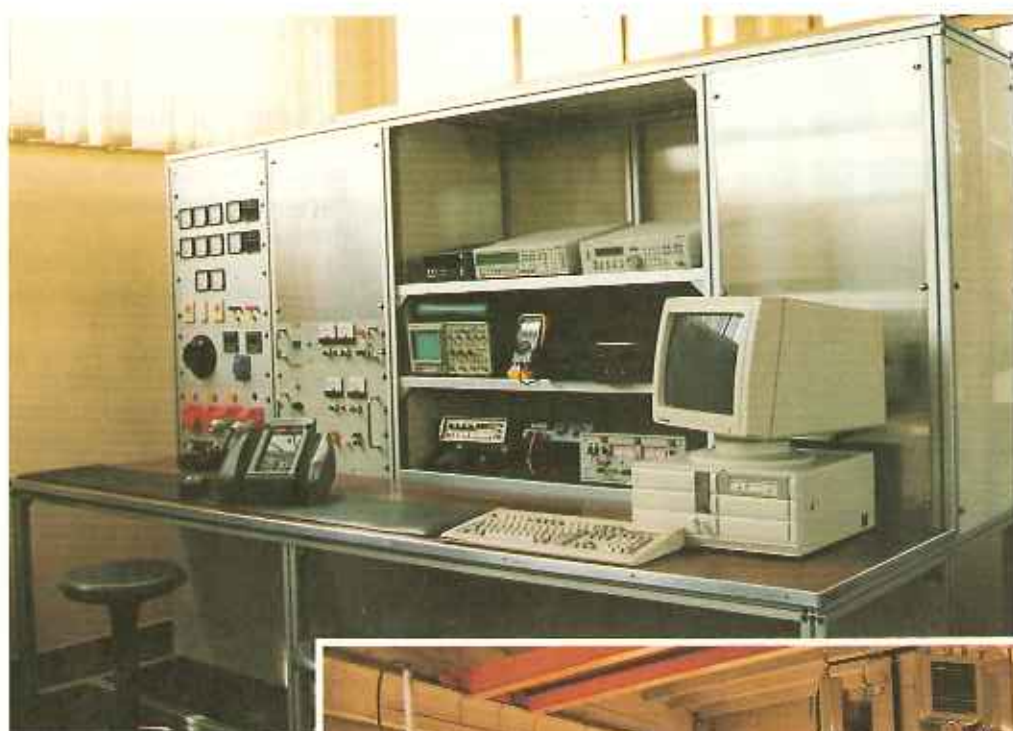
Banco prova affidabilità iniettori, realizzato da Masmec. L'azienda opera in regime di assicurazione della Qualità secondo la norma UNI EN 29000
