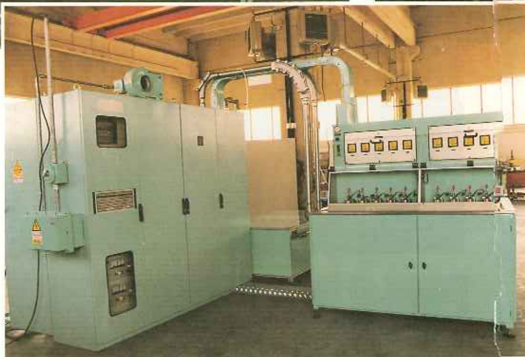
Banco prova affidabilità iniettori, realizzato da Masmec. L'azienda opera in regime di assicurazione della Qualità secondo la norma UNI EN 29000
