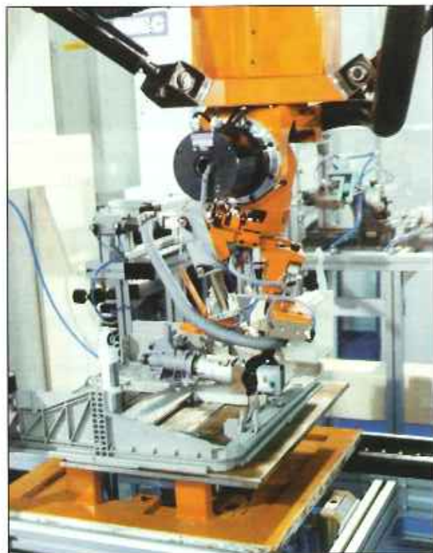
▼ Fig. 3 La Ipkm nella sua attività di montaggio del tubo di scarico sul basamento della lavatrice
