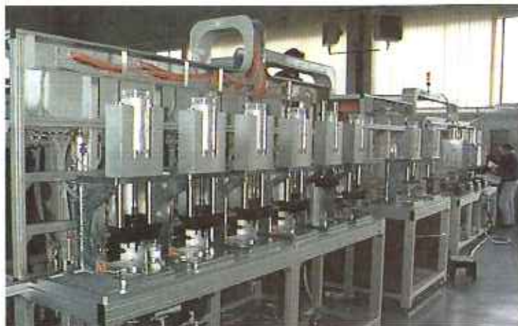
La taratura viene effettuata sfilando il tassello spingimolla, che dà il carico sulla valvola, attraverso l'impiego di un motore a passo che ha come feedback le informazioni relative alla portata del circuito idraulico
