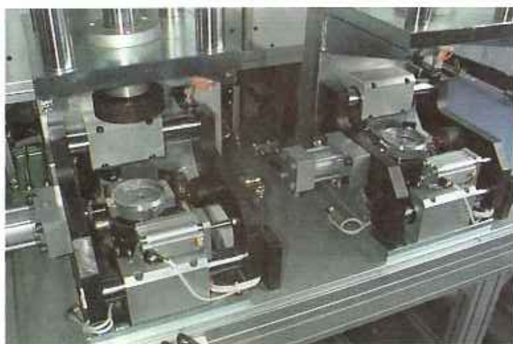
La taratura viene effettuata sfilando il tassello spingimolla, che dà il carico sulla valvola, attraverso l'impiego di un motore a passo che ha come feedback le informazioni relative alla portata del circuito idraulico
