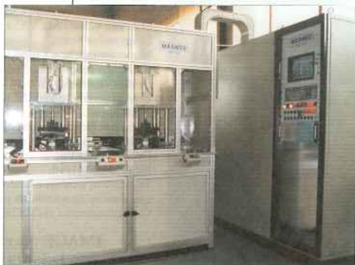
Il primo banco consegnato a Marzocchi pompe è composto da due postazioni di lavoro, uguali e indipendenti, ed esegue il rodaggio e il collaudo completo della pompa
