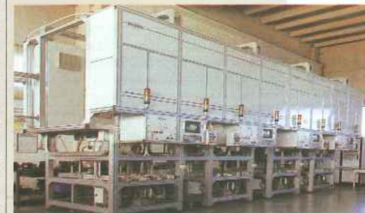
Un sistema di collaudo di compressori per frigoriferi.
