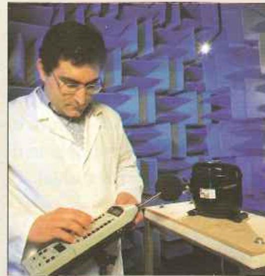
La prova della rumorosità di un compressore in camera anecoica.
