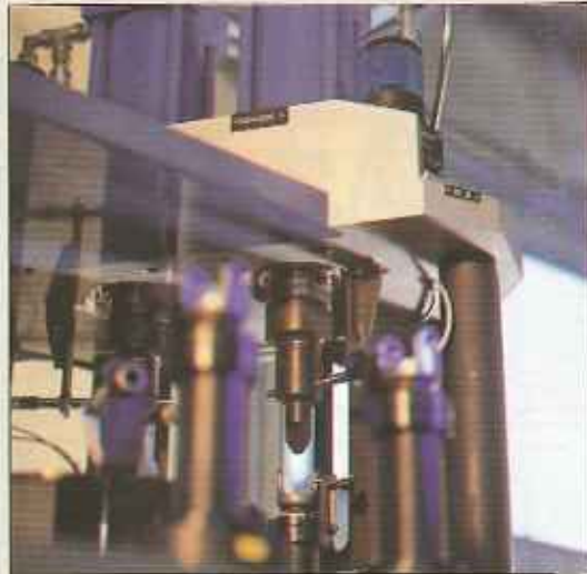
Una stazione di assemblaggio di un componente dell'albero dello sterzo.
