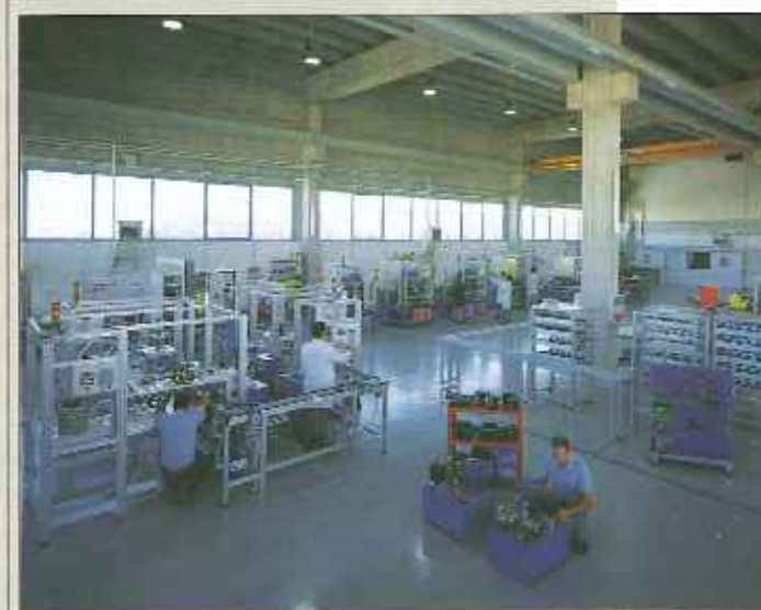
Un reparto in Masmec. In primo piano, la linea di assemblaggio per bilancieri dei motori e, dietro, linee di assemblaggio e prova dell'albero dello sterzo per automobili di medie dimensioni.
