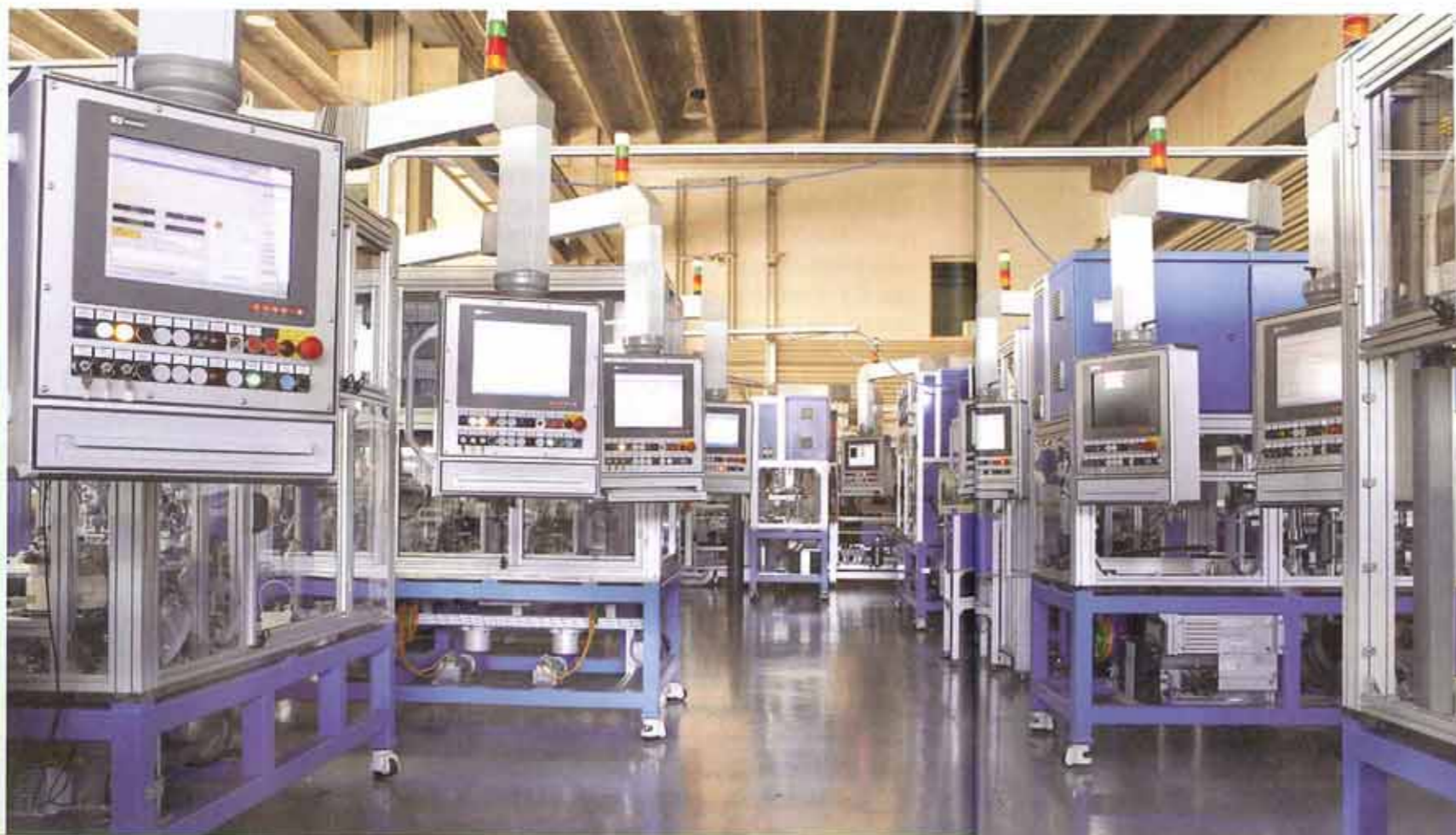
Linea di assemblaggio per iniettori benzina in alta pressione.
